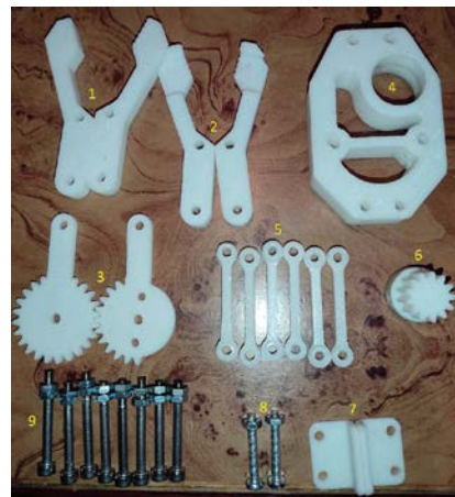
Slika 7. Mehanički delovi hvatača manipulatora: (1) Donji delovi prstiju; (2) Gornji delovi prstiju; (3) Gonjeni zupčanci; (4) Baza; (5) Balansireri; (6) Pogonski zupčanic; (7) Nosači; (8) Dva vijka sa ravnim prihvatom M30x20 sa dve navrtke; (9) Osam imbus vijaka M30x30 sa 16 navrtki.
