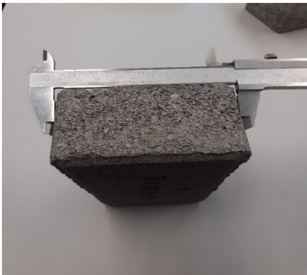
Slika 2. Merenje uzoraka betonskog bloka primenom pomičnog merila
