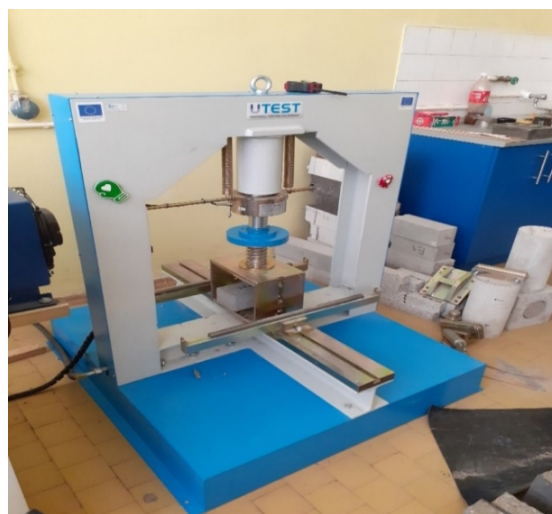
Slika 4. Postupak ispitivanja čvrstoće pri zatezanju cepanjem
