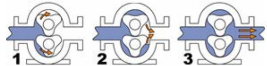
Slika 7. Princip rada lobe pumpe.
