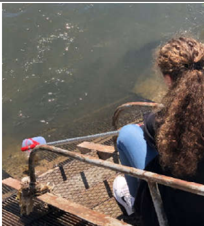
Слика 2. Узимање узорака воде уз помоћ телескопског штапа.
