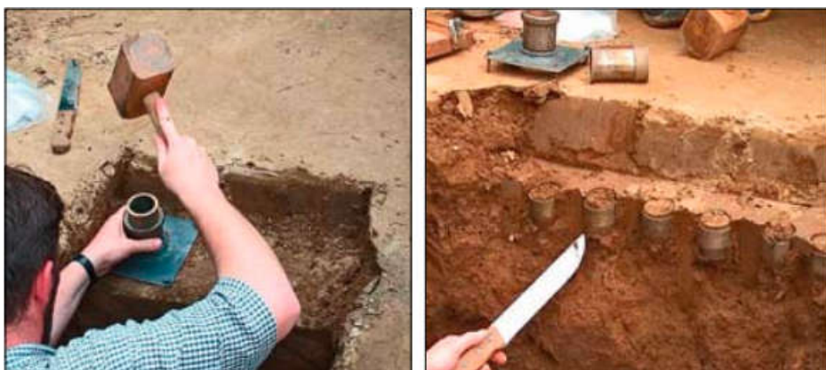
Слика 5.2.1 Узимање узорака у природно ненарушеном стању цилиндрима по Копецком
