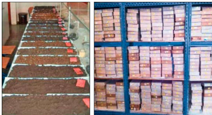
Слика 5.2.2 Сушење и чување узорка земљишта у нарушеном стању.
