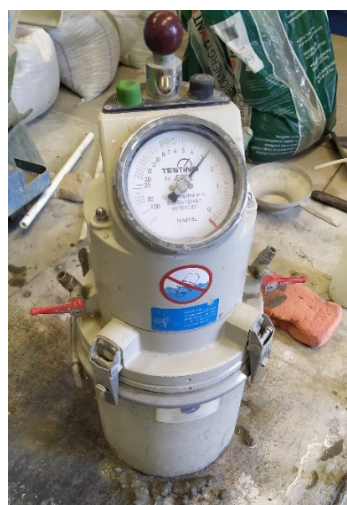
Slika 2. Ispitivanje procenta uvučenog vazduha u svežu betonsku masu.
