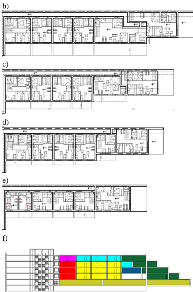
Slika 5. Stambene jedinice tipskih osnova zgrade C (a, b, c, d, e) i prikaz rasporeda različitih tipova stambenih jedinica u preseku kroz središnji hodnik zgrade (f).
