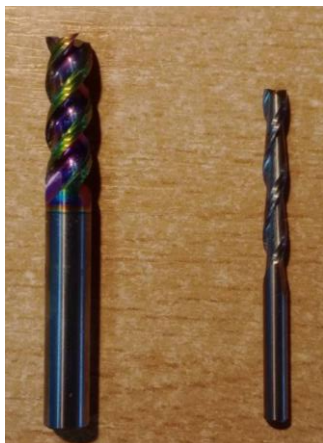
Slika 7. Glodala korišćena za izradu stalka za noževe.
