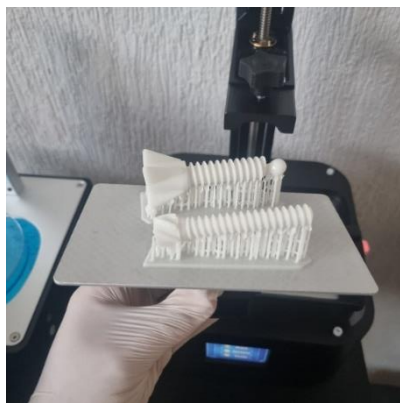
Slika 4. Delovi nakon završetka štampe.
