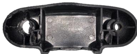
Slika 2. Trajno oštećen nosač naslona radne stolice [3].
