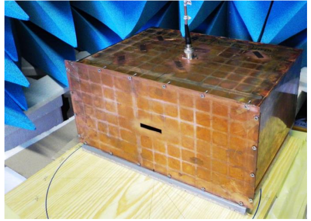
Slika 1 Fizički model pravougaonog metalnog kućišta sa jednim pravougaonim otvorom.
